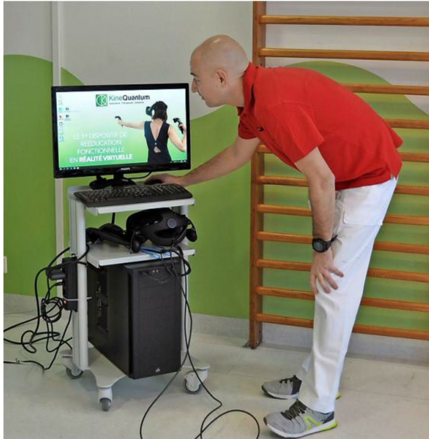
Bastien Belmondo, chef de service de physiothérapie du HIB prépare KineQuantum. L'équipement est «tout simple» et ne prend pas beaucoup de place. Il implique encore la pose de deux capteurs pour saisir les mouvements du patient dans l'espace et les appliquer à la réalité virtuelle. PHOTO DAP
